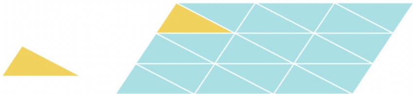
FIGURE 21 – Pavage monoédrique du plan par des triangles non réguliers.
