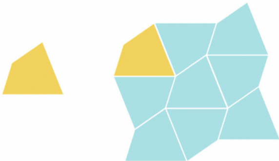
FIGURE 22 – Pavage monoédrique du plan par des quadrilatères non réguliers convexes.
