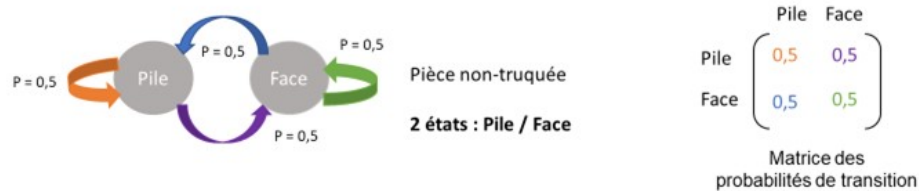
FIGURE 3.5 : Illustration simple d'une chaîne de Markov à temps discret avec la matrice des probabilités de transition pour passer d'un état à un autre.
